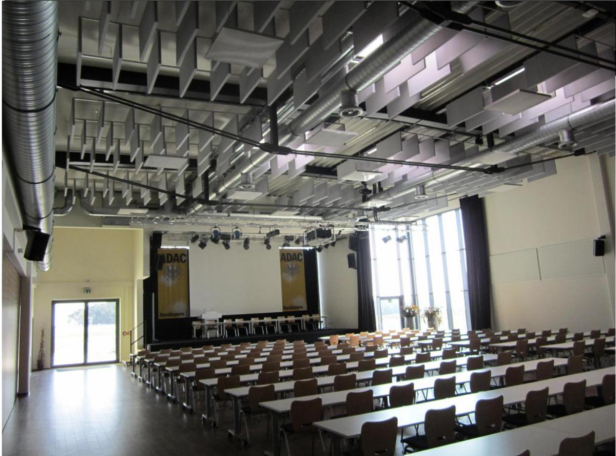
In diesem Tagungssaal wurden die Schallschutzelemente sowohl an der Decke als auch an den Wänden angebracht. Vor allem an den Wänden fallen sie dem Betrachter kaum auf.
